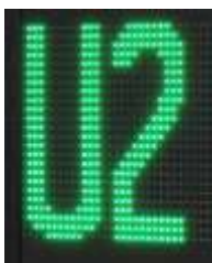
Obrázok 6 Príklad zobrazenia čísla linky na bočnom paneli - ľavý bok vozidla
