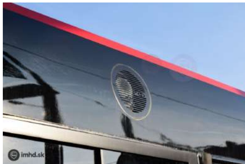
Obrázok: Mriežka so zabudovaným reproduktorom pre nevidiacich v blízkosti predných dverí na autobuse MHD Bratislava. Zdroj: iMHD.sk/BA
