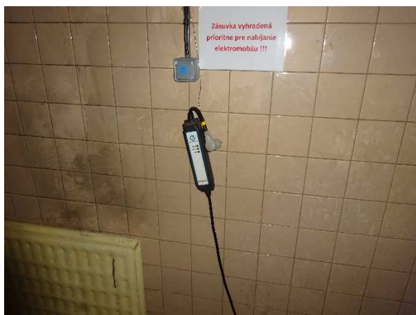
Obrázok 34 – Napájací adaptér pre Nissan Leaf
