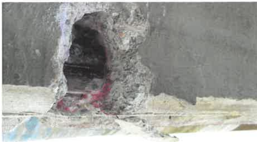
Obrázok 16: Zisťovanie hĺbky karbonatizácie
