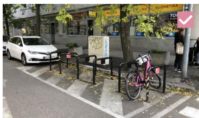
Vhodne osadené stojany v parkovacom páse v blízkosti priechodu pre chodcov. V takýchto prípadoch je vhodné dodatočné osadenie iných ochranných prvkov (carstopy, stĺpiky, balisety) v perimetri parkovacieho miesta
