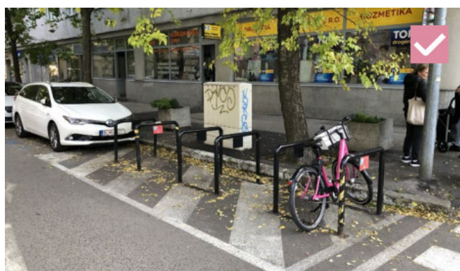
Vhodne osadené stojany v parkovacom páse v blízkosti priechodu pre chodcov. V takýchto prípadoch je vhodné dodatočne osadenie iných ochranných prvkov (carstopy, stĺpiky, balisety) v perimetri parkovacieho miesta
